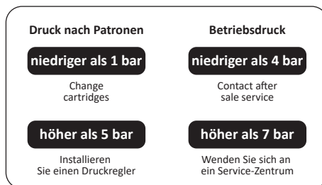
Abbildung 6. Betriebsparameter des Systems
